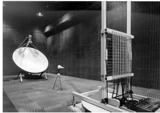
図15 京都大学マイクロ波送電実験設備
